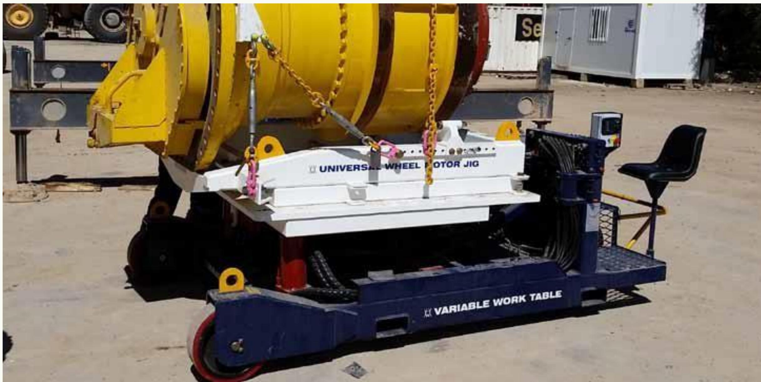
La mesa de trabajo Variable 15 ha sido diseñada y fabricada para proporcionar la versatilidad necesaria para manipular de manera segura una gama de componentes de camiones de movimiento de tierra de gran tamaño con una capacidad de transporte de hasta 240 toneladas.
